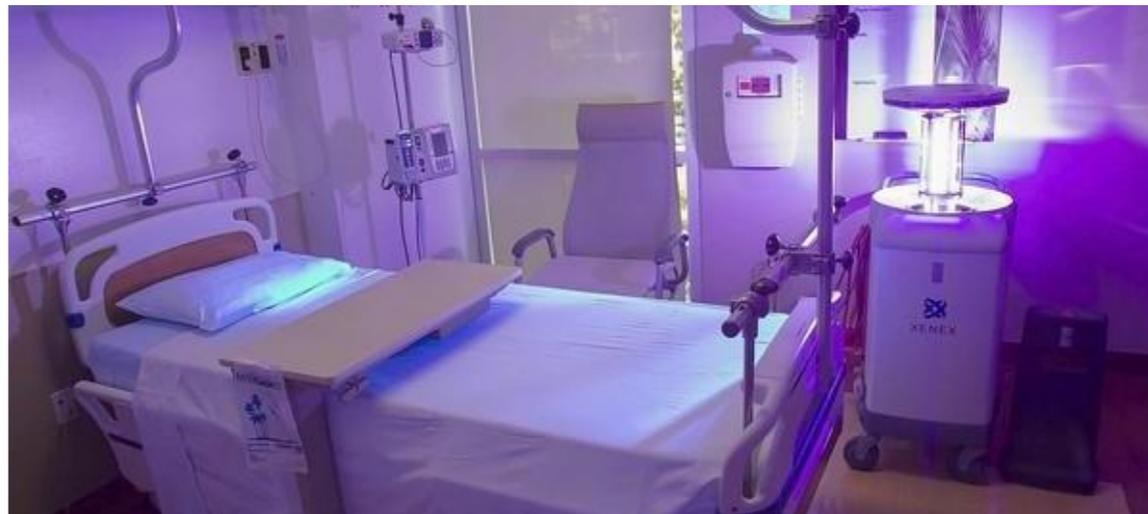
XENEX公司PX-UV机器人
