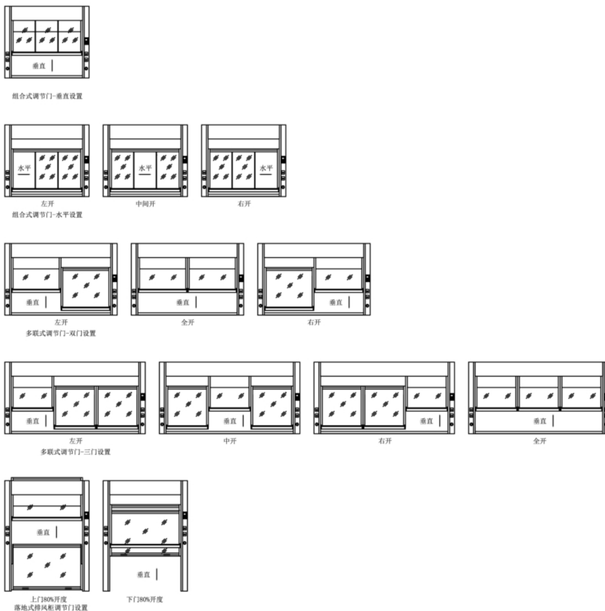
图E.1 调节门试验操作开口设置
