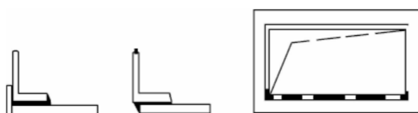
图 3.2.1-2 风管法兰焊接形式
