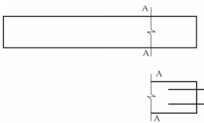
图 10.4.5 构件局部不同的简化画法
