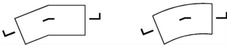
图 10.3.2-3 两个相交的剖切面剖切
