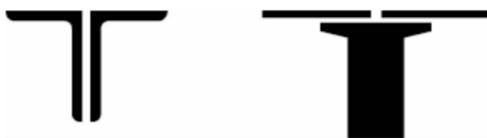
图 9.1.1-2 相邻涂黑图例的画法
