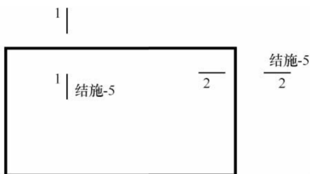
图 7.1.4-2 断面的剖切符号
