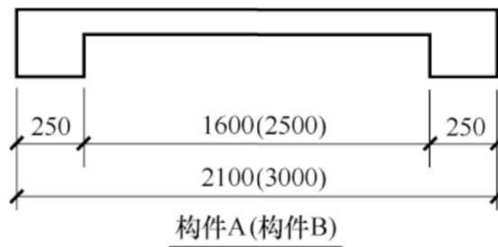
图 11.7.5 相似构件尺寸标注方法
