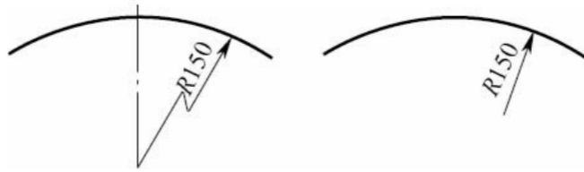
图 11.4.3 大圆弧半径的标注方法
