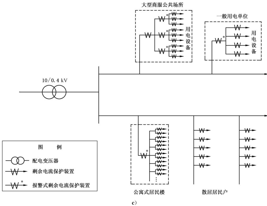
注 1：图 C.1 a) 所示分级保护模式适用于农村电网中、小型配电变压器(160 kVA 以下)供电的架空配电网,其主要负荷为农副业加工及居民生活用电,可采用设电源为第一级保护的三级保护方式。
