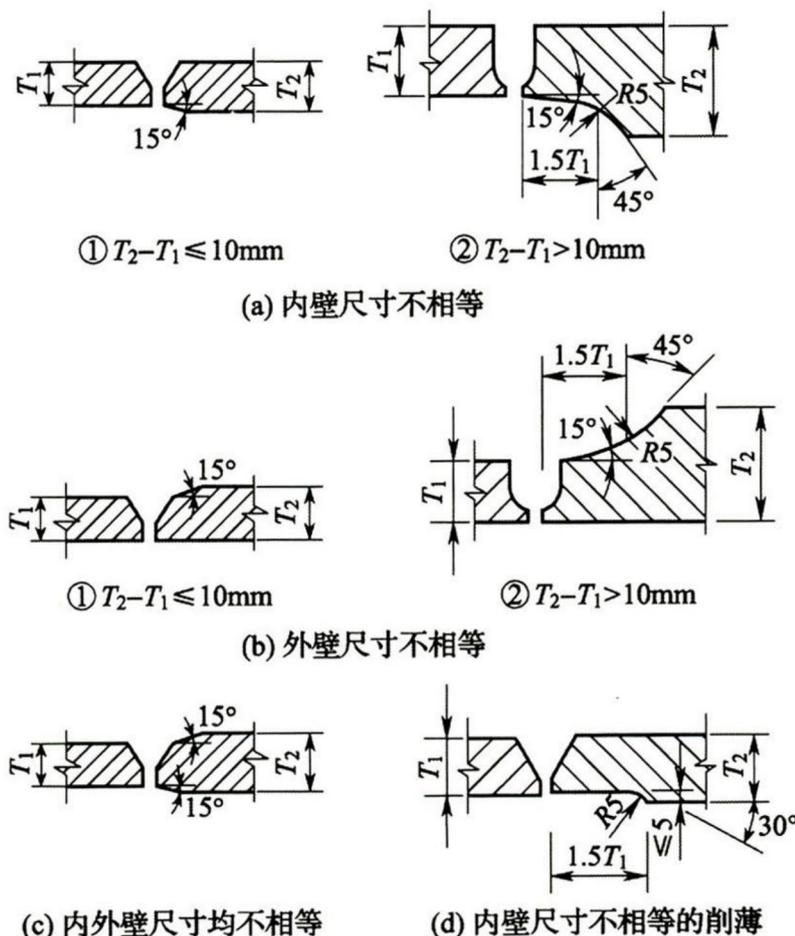
图 7.2.8 不等厚对接焊件坡口加工
