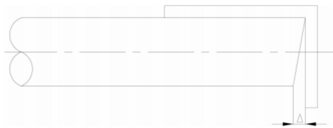
图 5.2.4 管子切口端面倾斜偏差
