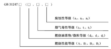
示例:GB 31247  $B_1$ - $(d_0$ ,  $t_1$ ,  $a_1$ )表示电缆或光缆的燃烧性能等级为  $B_1$  级,燃烧滴落物/微粒等级为  $d_0$  级,烟气毒性等级为  $t_1$  级,腐蚀性等级为  $a_1$  级。
